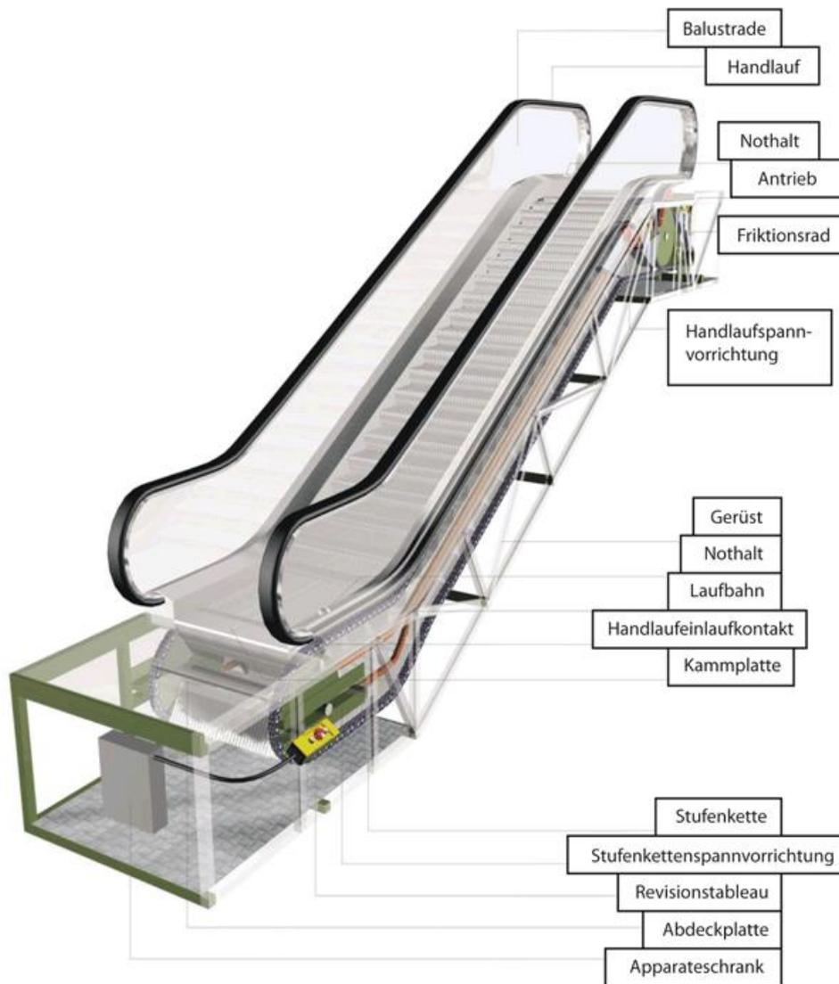
Abbildung 2: Aufbau einer Fahrtreppe. (Quelle: Schindler Aufzüge und Fahrtreppen GmbH, Berlin)
