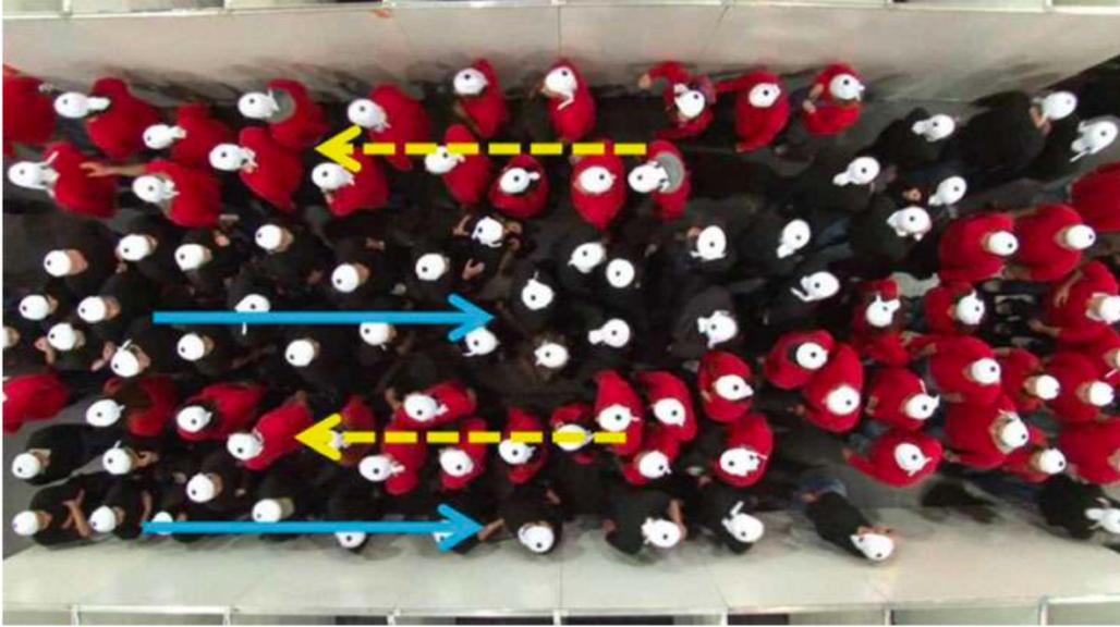
Abbildung 3: Linienbildung mit je zwei Linien bei Gegenverkehr [1, s.9]
