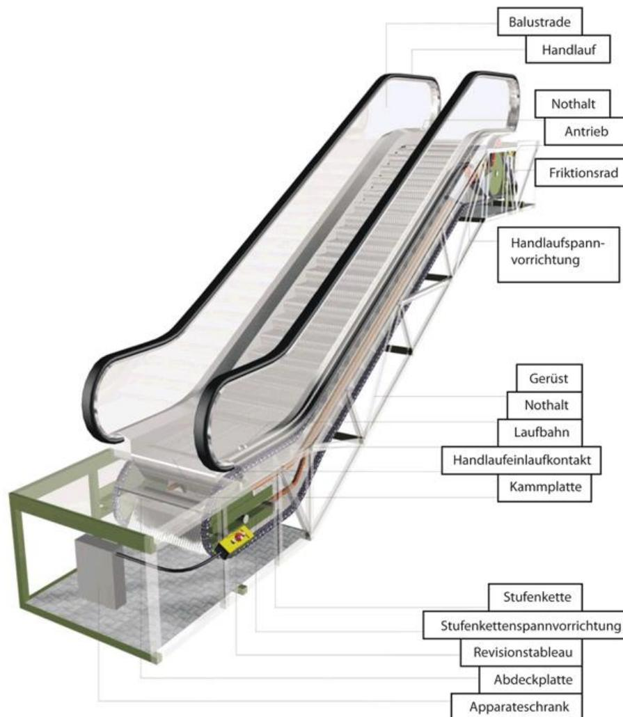
Abbildung 20: Aufbau und Komponenten einer Fahrtreppe ([56, p. 210] zit. n. [57])
