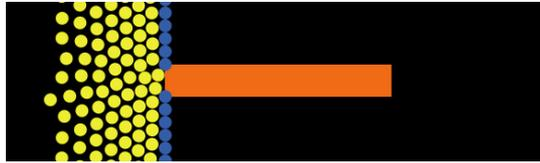
Abbildung 39: Verstopfung bei einer Agentengröße  $l$  von 0.35 m bzw. 0.40 m
